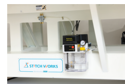
自動給油装置 [標準装備] メンテナンス負担を軽減し、安定稼働をサポート。
